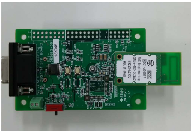
図 6 通信モジュール並びに I/F ボード
