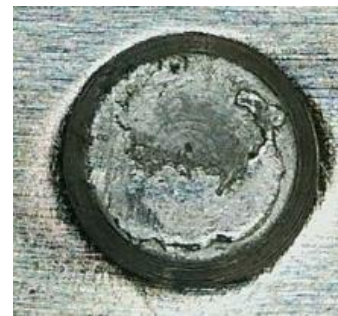
図4 電極接触部のアルミ板表面 (溶接電流 6.0 kA)
