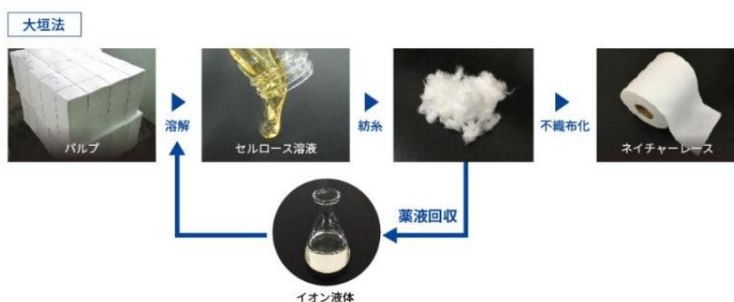
Fig. 1 大垣法による再生セルロース不織布の製造 (フタムラ化学ホームページ<sup>2)</sup>より)
